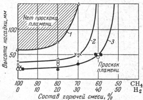
Рис. 14. Критическая высота насадки из гравия и шариков для горючей системы метан—водород—воздух в огнепреградителях рудничного газа при D = 200 и 400 мм:
