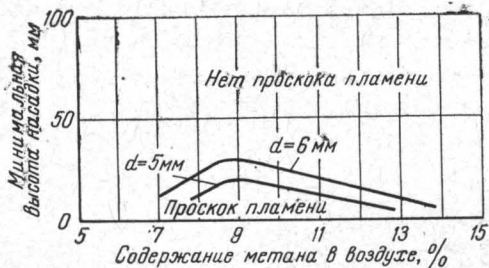
Рис. 13. Зависимость минимальной высоты насадки из стеклянных шариков от содержания метана в воздухе при D_y=400 мм.
